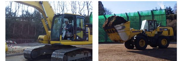
▲トラックから降ろしたチップを移動させたり、混ぜたりします ▲サイロに燃料を投入します
